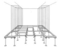
Verzinkter C-Profil-Rahmen mit Hammerkopfschrauben und Zahnscheiben auf den höhenverstellbaren Stützen verschraubt
